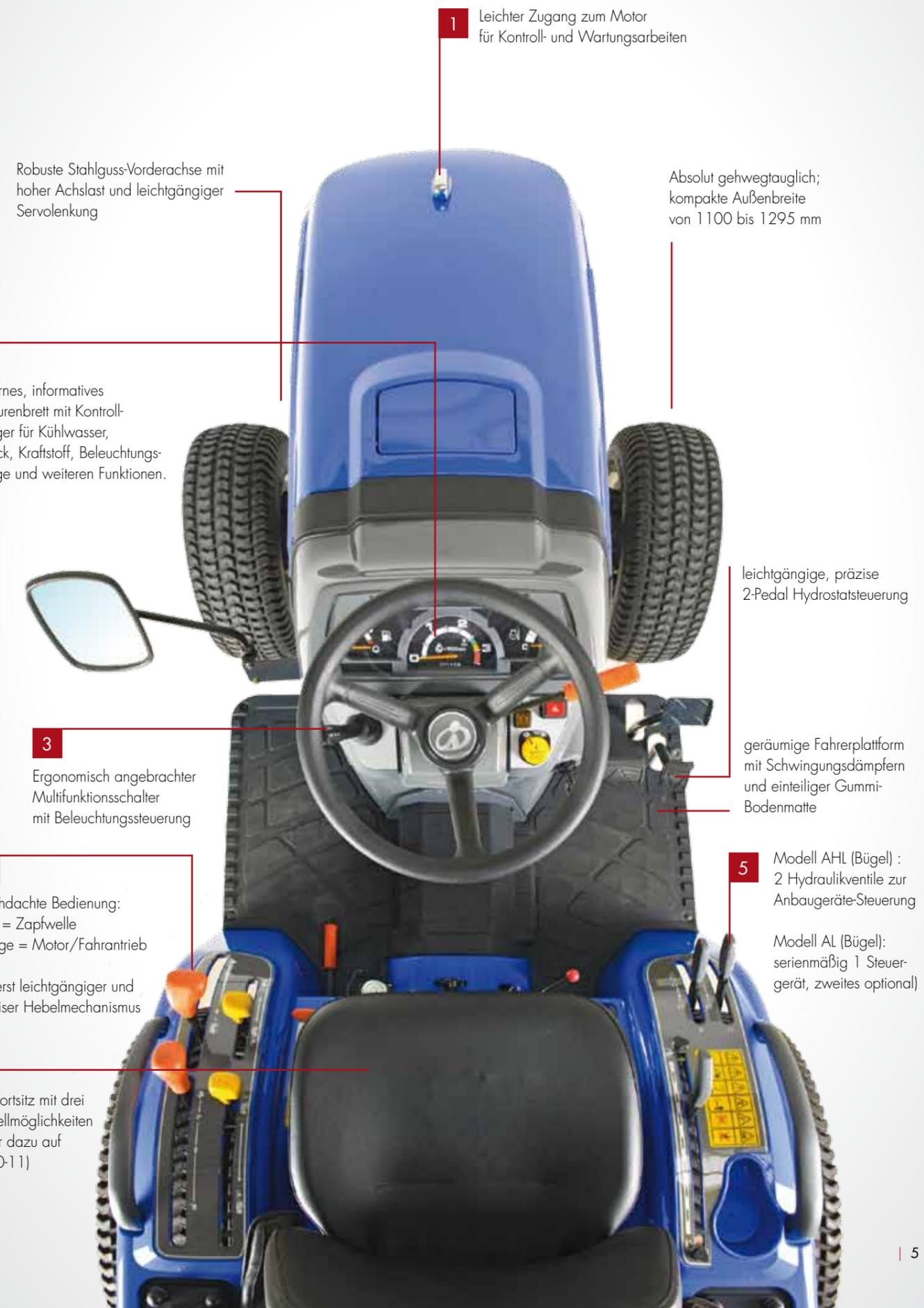
1 Leichter Zugang zum Motor für Kontroll- und Wartungsarbeiten
