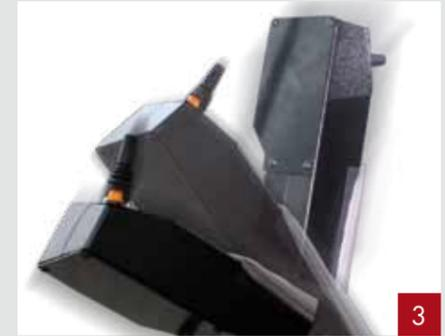
Die Joystick-Kommandozone zur kompletten Hydrauliksteuerung ist in Höhe und Länge verstellbar.
