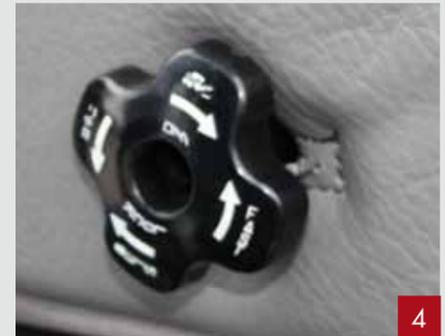
Die Senkdrossel zum Betrieb der Dreipunkthydraulik ist bedienerfreundlich unter dem Fahrersitz positioniert.
