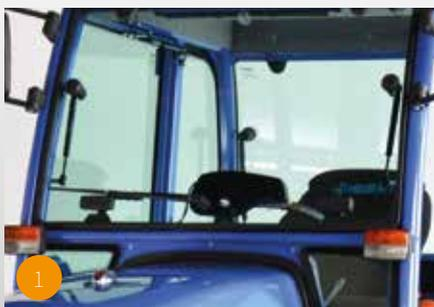
Der unten montierte Wischermotor garantiert ein maximales Sichtfeld und erhöht damit die Fahrsicherheit bei Regen und Schnee.
