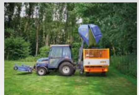
Beispiel: TH 4365 im Mäheinsatz mit Grassammelbehälter GLS1260 und Frontmäherwerk FM160. Fotos rechts: ISEKI-Anhänger mit Gitteraufbau.
