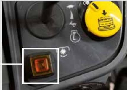
Die TH 4000 Kommunaltraktoren sind mit 3 separat schaltbaren Zapfwellen ausgestattet, deren Aktivierung über den ISEKI-Softanlaufschalter den absolut behutsamen Anlauf der Anbaugeräte ermöglicht.
