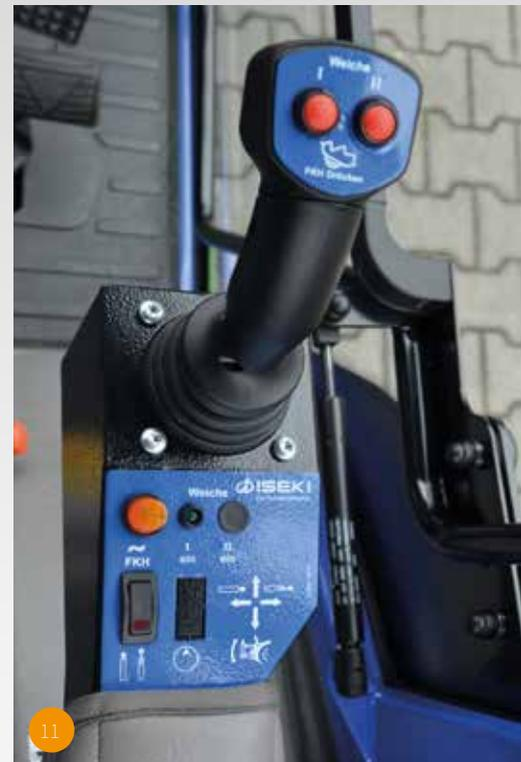
Die Hydraulikfunktion ist elementar, um Anbaugeräte zu steuern und letztlich produktiv zu arbeiten. Daher bieten wir eine klappbare Armlehne mit elektrohydraulischer Steuerung – multifunktional und mit nur einer Hand bedienbar!
