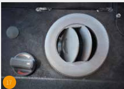
Das leistungsstarke Heizgebläse liefert die Luftzufuhr für die variabel verstellbaren Verteilerdüsen.
