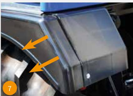
Die hinteren Kotflügel sind in der Breite verstellbar. Dadurch lassen sie sich an verschiedene Reifenbreiten anpassen und garantieren damit optimalen Schutz vor aufwirbelndem Wasser, Schmutz und Salz im Winterdienst. Das ist eine echte ISEKI Systemlösung. Bei „spritzigen“ Einsätzen, wie z. B. auf dem Ackerfeld oder auf nassen Straßen kommt es ohne Kotflügel schnell zu Verschmutzungen der Fahrerkabine.
