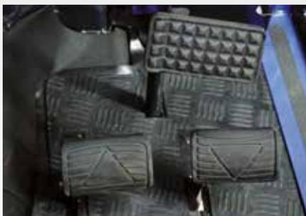
Der Wechsel von Vor- und Rückwärtsfahrt erfolgt über eine komfortable leichtgängige 2-Pedal-Hydrostatsteuerung mit nebeneinander liegenden Fußpedalen.
