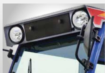
Im Dach integrierte Zusatzhauptscheinwerfer sorgen für eine optimale Ausleuchtung des Arbeitsbereiches – besonders im Wintereinsatz. Zugleich sind die Scheinwerfer anfahrteschützt.
