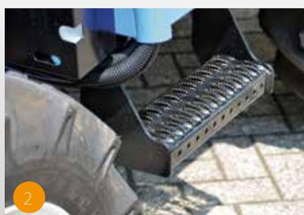
Zwei stabile Trittstufen unterhalb der Kabinentür erleichtern den Ein- und Ausstieg.
