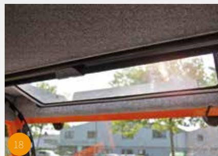
Das Panoramafenster im Dachhimmel sorgt für eine optimale Sicht auch nach oben (Verkehrsampeln, Frontladereinsatz).
