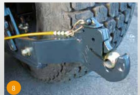
Schnellwechsel-Fanghaken zum flinken und sicheren Wechsel der Anbaugeräte (optionale Ausrüstung).
