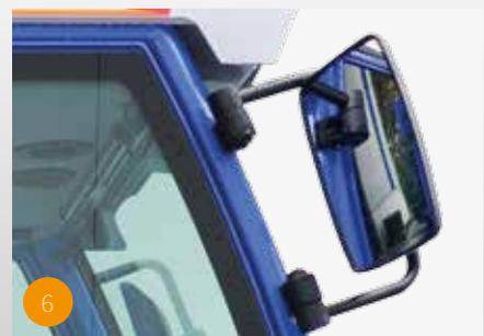
Robuste Doppelarmbefestigungen verhindern Bruchschäden und unbeabsichtigtes Verstellen.
