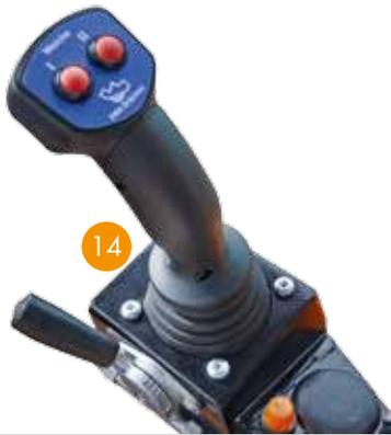
Mit dem Joystick wird die Front- und Heck-Hydraulikanlage gesteuert. So können Anbaugeräte bequem bedient werden. Mehr auf Seite 20.
