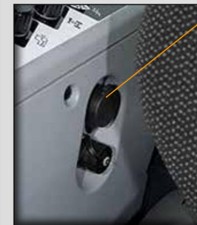
Die Kabinenmodelle der TG-Baureihe verfügen neben einer 12 Volt-Steckdose auch über einen genormten Zusatzanschluss, der das Fahrsignal ausgibt. Dies kann zum Beispiel im Einsatz mit einem wegeabhängigen Streuer verwendet werden.
