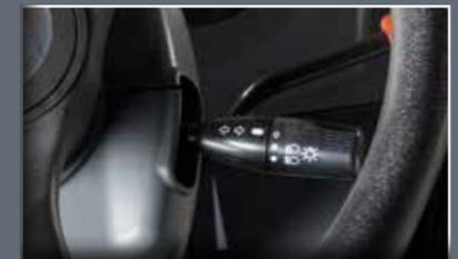
Der Lenkstockhebel beinhaltet Funktionen wie die Lichtsteuerung und den Blinker und wird nach dem Durchfahren von Kurven automatisch zurückgestellt.
