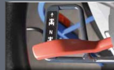
Die Wendeschaltung ist unmittelbar griffbereit und vor versehentlicher Bedienung geschützt unter dem Lenkrad angeordnet.
