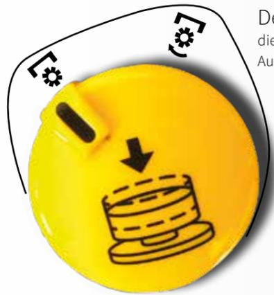
Der Zapfwellenschalter dient zum Ein- und Auskuppeln der Zapfwelle.
