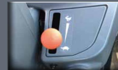
Der Handgashebel steuert die Motordrehzahl und verbleibt in der gewählten Position. Bei nach vorne geschobenem Handgashebel läuft der Motor im Leerlauf. Die Motordrehzahl steigt an, wenn der Hebel nach hinten gezogen wird.
