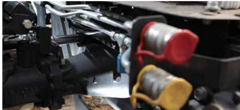
Hydrauliksystem mit stabilen, wartungsfreien Stahlrohr-Leitungen
