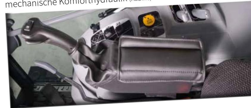
Die mechanische Komforthydraulik bietet alle Funktionen, die bereits der Standardkreuzsteuerhebel abbildet. Hinzu kommt hierbei aber eine ergonomisch verbesserte Position in einer integrierten Armlehne. Sie ist am Sitz befestigt und bildet mit Sitz und Joystick eine feste Einheit. Um den maximalen Komfort zu gewährleisten, ist die Armlehne in Neigung, Höhe und Längsrichtung individuell einstellbar.
