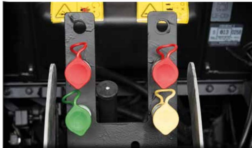
Zur Bedienung von Anbaugeräten im Heck stehen 4 Hydraulikanschlüsse im Zusammenspiel mit 2 Steuergeräten zur Verfügung. Hinzu kommen 2 weitere Dosen, sofern ein Ölmotorantrieb als Option gewählt wurde.
