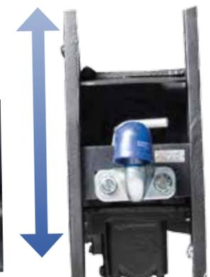
Optional sind in der Höhe frei einstellbare Kupplungen mit Rastschiene erhältlich. Diese lassen sich individuell auf das zu ziehende Gerät einstellen.
