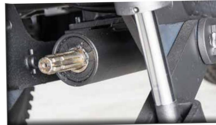
Die optionale Frontzapfwelleinheit ist zwischen Traktorenfront und dem Frontkraftheber montiert. Sie zeichnet sich durch eine Verlängerung in Frontrichtung gegenüber der serienmäßigen Zwischenachs-Zapfwelle aus. Dies spiegelt sich in deutlichen Vorteilen hinsichtlich Anbaulänge, Gelenkwellenbeugung und Gerätekosten wider.
