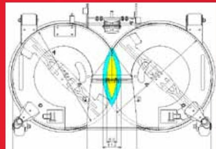
Durch die große Überlappung der beiden Messerkreise wird eine hervorragende Schnittqualität erreicht.
