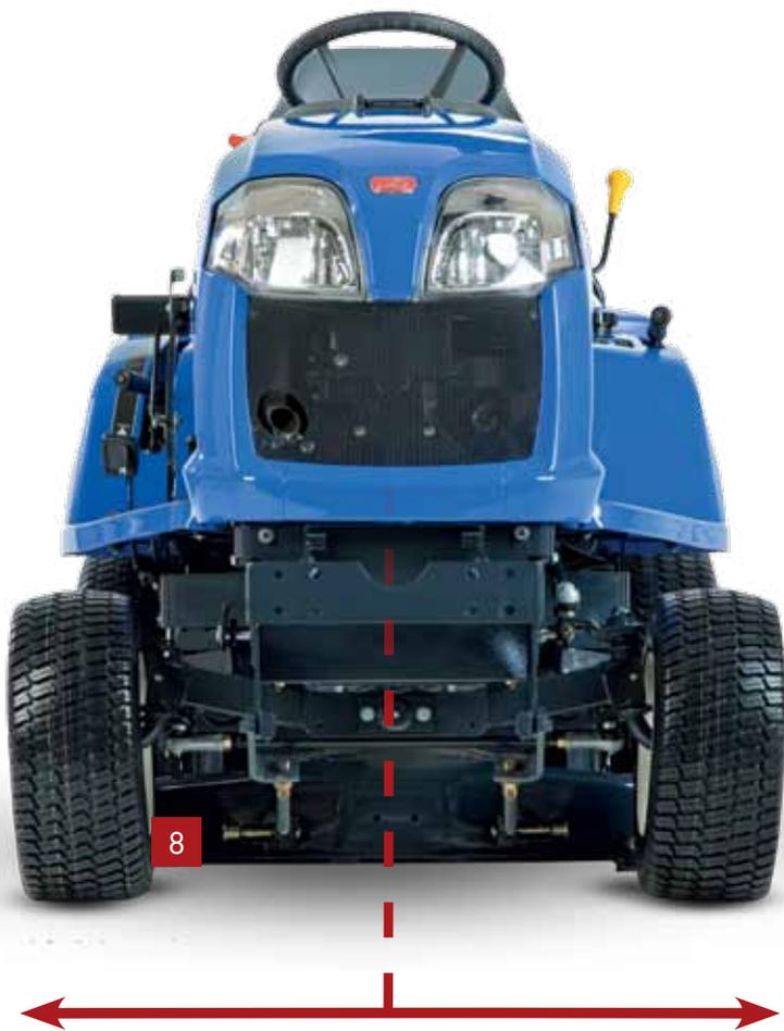
Durch die zentrale Position des Mähdecks können links- und rechtsseitig Mähkanten perfekt ausgemäht werden.
