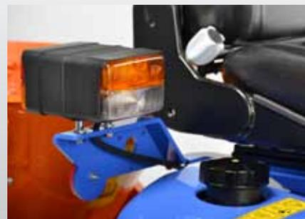
Einfach und sicher: Der Tankstutzen befindet sich nicht vorn im Motorbereich, sondern heckseitig neben dem Fahrersitz.
