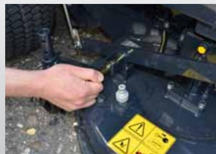
Am Mähwerk befinden sich jeweils rechts- und linksseitig Federbolzen, die werkzeuglos herausgezogen werden können. Das Mähwerk kann damit schnell und einfach vom Fahrzeug demontiert werden.
