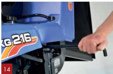
Immer mit dabei: Im seitlich hinteren Teil des Fahrzeugs ist ein spezieller Reinigungshaken integriert.
