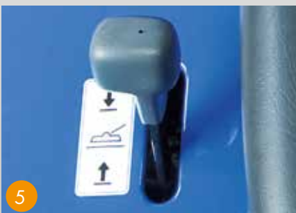
Steuerhebel zum Senken und Heben des Mähdecks (Foto links) sowie zur Betätigung des Sammelbehälters (Hochentleerung, Foto rechts).
