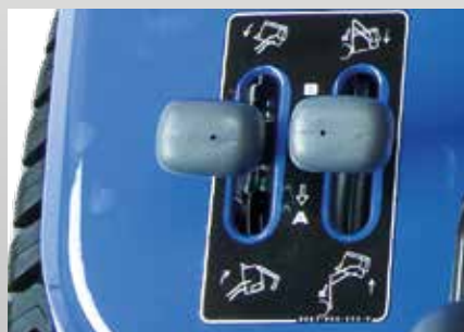
Steuerhebel zum Senken und Heben des Mähdecks (Foto links) sowie zur Betätigung des Sammelbehälters (Hochentleerung, Foto rechts).
