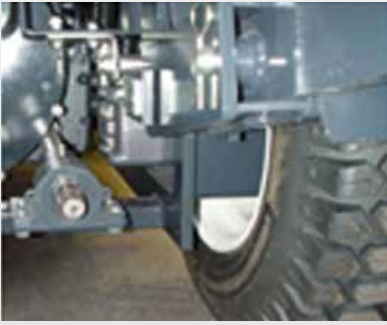
vollhydraulischer Antrieb vorn (Radmotoren)
