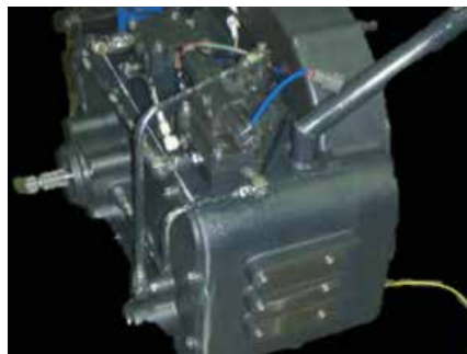
Mechanisches Zapfwellengetriebe mit wählbarem Power- und Eco-Modus
