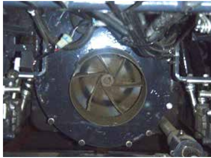
Hochleistungs-Saugturbine aus Stahl
