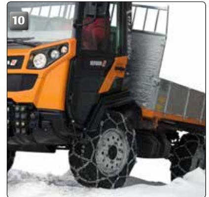
Zwischen Vorder- und Hinterachse sorgt das 360° drehbare **Zentralgelenk (10)** für ständige Bodenhaftung aller 4 Räder und gewährleistet sicheres Fahrverhalten in jeder Situation. Sie haben volle Kraftübertragung und optimale Bodenschonung auch im unwegsamen Gelände.
