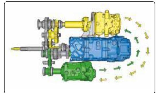
Im **mechanischen Modus** sind die Hydraulikkomponenten vom Antriebsstrang getrennt. Der Antrieb erfolgt zu 100% mechanisch (blau) ohne jegliche Wirkungsgradverluste durch das Hydrauliksystem.
