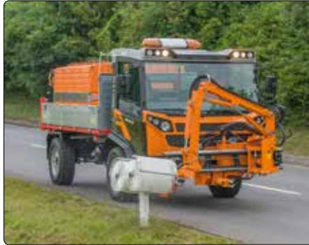
Anwendungen wie Parkplatzschneeräumung sowie Leitpfostenreinigung bedürfen häufiger Richtungswechsel respektive Stop and Go Betrieb. Ein **hydrostatischer Antrieb** ist hierfür die optimale Lösung.
