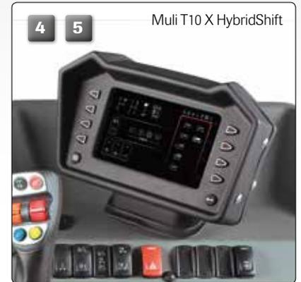
Zusätzlich zum Zentralinfor-mationsboard ist im Muli T10 X HybridShift ein **Bedienerleitsystem (5)** integriert. Hier kann der Fahrer die ge-wünschte Tätigkeit einstellen und das Bediener-leitsystem schlägt ihm alle wichtigen Einstellungen des Fahrzeuges vor.
