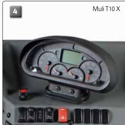
Das mittig in der Kabine angeordnete **Zentralinfor-mationsboard (4)** zeigt dem Fahrer auf einen Blick alle wichtigen Informationen und Daten. Durch die seitliche Montage wird die Sicht auf das Zentralinfor-mationsboard nicht durch das Lenkrad beeinträchtigt.
