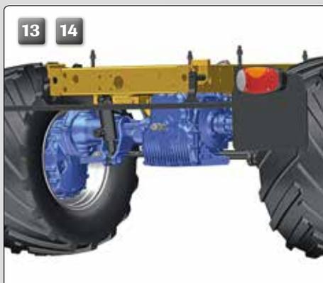
Die Vorder- und Hinterachse sind als **Portalachsen (13)** ausgeführt. Diese Bauweise ergibt eine größtmögliche Bodenfreiheit, mit entsprechender Durchgangshöhe zwischen den Rädern. Die Bodenfreiheit beträgt 450 mm.
