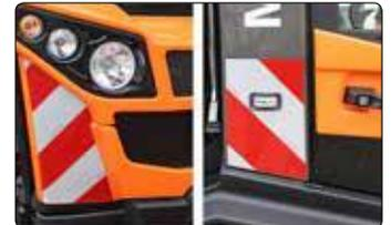
Speziell für den kommunalen Einsatz ist ein **Warnmarkierungssatz** erhältlich, um besonders bei Nacht früher gesehen zu werden.
