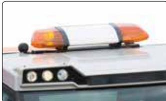
Das **optische Warnsystem** lässt sich auf dem Dach des Muli montieren und kann individuell beschriftet werden.
