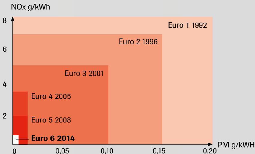
Die Verschärfung der Abgasstufen dient der Reduktion von verschiedenen Schadstoffen in den Abgasen von Dieselmotoren.
