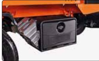
Die spritzwasserdichte und abschließbare **Werkzeugkiste** aus Polyethylen bietet genügend Stauraum für Zurrgurte, Werkzeuge oder Zubehör.
