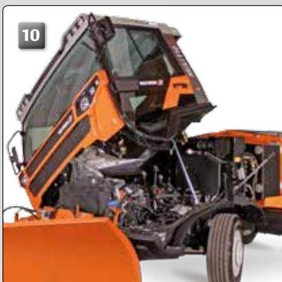
Die **serienmäßige Kippkabine (10)** des Muli T10 X ermöglicht es für Wartungs- und Reparaturarbeiten rasch an den Motorraum zu gelangen. Die werkzeuglos, hydraulisch zur Seite kippbare Kabine lässt sich in kürzester Zeit anheben. Durch das seitliche Kippen müssen Frontanbaugeräte wie ein Schneepflug oder Mähwerk nicht demontiert werden.
