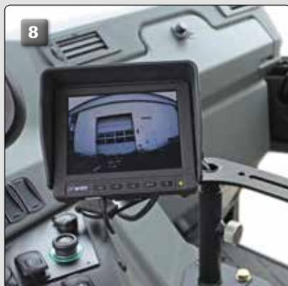
Viele Anbaugeräte verfügen über eine eigene Bedieneinheit oder Anzeigedisplays (z.B. Rückfahrkamera). Diese können mittels einer eigens entwickelten **Monitorhalterung (8)** optimal in der Muli-Kabine platziert werden. Per Kabeldurchführung in der Rückwand lassen sich Kabel zwischen Anbaugerät und Bedieneinheit platzsparend und sauber in die Kabine führen. Optional sind Impuls- oder Leistungssteckdosen für Anbaugeräte möglich.
