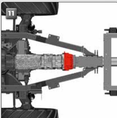
Das sperrbare **Längsdifferenzial (11)** ist zwischen Vorder- und Hinterachse positioniert und sichert, in Verbindung mit dem permanenten Allradantrieb, maximale Kraftübertragung auf den Boden. Verspannungen zwischen Vorder- und Hinterachse, die bei Kurvenfahrten oder Bodenunebenheiten auftreten können, werden ausgeglichen. Wird das Längsdifferenzial gesperrt, teilt sich die Antriebskraft gleichmäßig (1/1) auf die Vorder- und Hinterachse auf.
