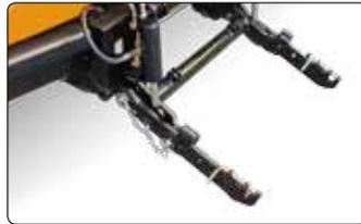
Das **Front-3-Punkt-Hubwerk** mit Gabeln ist mit elektrohydr. Geräteentlastung sowie Schwingungsdämpfung erhältlich.
