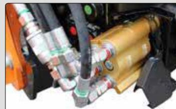
Die Fronthdraulik kann mit einem 4-fach **Multikuppler** ausgerüstet werden. Der Gerätewechsel ist somit noch schneller und einfacher möglich.
