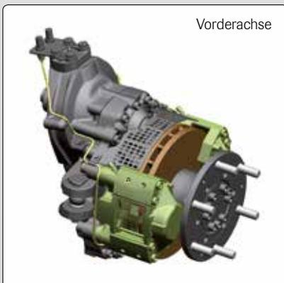
Serienmäßig ist der Muli T10 X vorne und hinten mit **innenbelüfteten Scheibenbremsen** ausgestattet. Durch die Erhöhung des Brems Scheibendurchmessers wird die Bremswirkung deutlich erhöht. Optimale Wärmeabfuhr wird durch Bohrungen in den Felgen gewährleistet. Geringe Pedalkraft und hohe Bremswirkung zeichnen die Zweikreis- Vierrad-Servobremse aus. Zur Serienausstattung zählt natürlich auch der Bremskraftverstärker.
