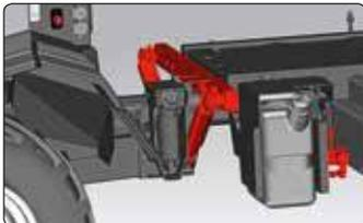
Für den Einsatz mit einem Kran ist eine **hydraulische Verdreharretierung** zwingend notwendig.
