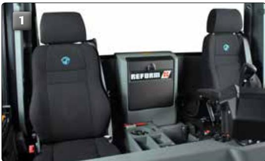
Ein **perfekt gefederter Sitz** schont den Rücken und erhöht den Komfort deutlich. Die verschiedenen Modelle bieten alle ein Höchstmaß an Komfort und Sicherheit. Der Fahrer-, aber auch der Beifahrer-Sitz sind wahlweise mit mechanischer Federung oder luftgefedert erhältlich. Die hohe Rückenlehne und die optionale Sitzheizung sorgen für Freude bei der Arbeit.
