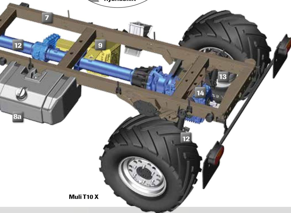
**7** Der massive **Hauptrahmen** dient als Befestigungsbasis für die zahlreichen Aufbaugeräte wie Kipper, Kran, Aufbaustreuer, Laubsauger, etc. Die Befestigung des jeweiligen Arbeitsgerätes erfolgt mit Schnellverschlüssen wie Anker- oder Augenschrauben.
