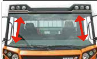
Im Dach des Muli T10 X lassen sich pro Seite bis zu 3 Arbeitscheinwerfer oder eine **Wechselbeleuchtung** für den Einsatz mit Frontanbaugerät montieren.
