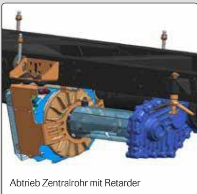
Abtrieb Zentralrohr mit Retarder
