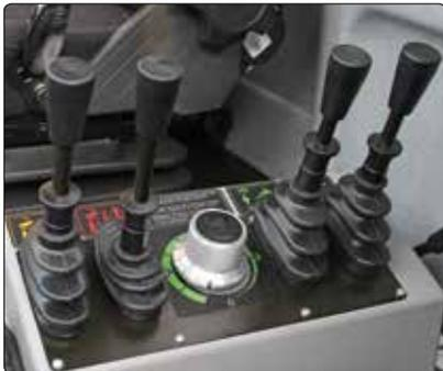
Die Betätigung der **Hydraulik** mittels mechanischen Steuergeräten wird beim Muli T7 S sehr geschätzt. Sie ist griffgünstig, seitlich neben dem Sitz angeordnet und gewährleistet eine ergonomische Bedienung.
