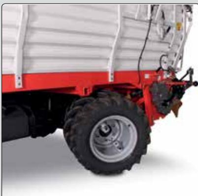
Beim REFORM PrimAlpin ist serienmäßig die Verwendung der **Allradlenkung** des REFORM Muli möglich. Engstellen wie Hofeinfahrten werden dadurch mühelos passierbar. Bei der Entwicklung wurde vor allem auf eine kompakte Bauweise, nahe an der Achse geachtet.
