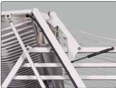
Durch ein innovatives Konzept, wird mit der **Hecktür** zusätzlich auch das Querrohr angehoben. Dadurch vergrößert sich die Öffnung und das Erntegut kann ohne Engpass entladen werden. Somit wird wertvolle Zeit eingespart.
