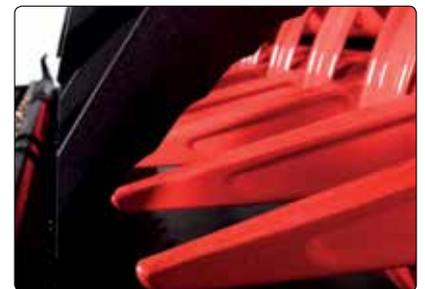
Robuste **Förderzinken** und optimale Messerteilung ermöglichen einen sauberen Schnitt.
