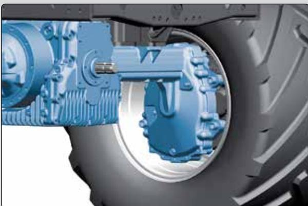
Antriebsstrang und Fahrwerk sind bei der S-Baureihe verstärkt. Die **höheren Portale** garantieren außerdem eine größere Bodenfreiheit. Durch das Reduziergetriebe in den Portalen ergibt sich eine wesentlich geringere Beanspruchung und somit Schonung des gesamten Antriebsstranges. Die Portale zeichnen sich überdies durch ein deutlich höheres Ölvolumen aus.
