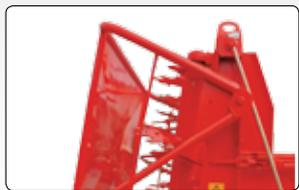
**Hydraulisch betätigte Heckschutzwand**
