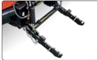
Das **hydr. 3-Punkt-Fronthubwerk** (am Frontanbaurahmen montiert) ist mit hydr. Geräteentlastung erhältlich.
