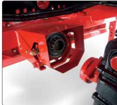
Rasch und werkzeuglos, **ohne Gelenkwelle**, erfolgt der Auf- und Abbau des Ladewagens dank des bewährten **REFORM Schnellkuppelsystems**. Für den Bediener bleiben die Betätigungskräfte sehr gering.
