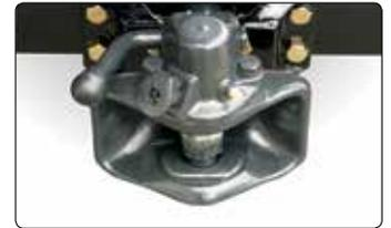
Automatische **Anhängekupplung** gibt es in drehbarer Ausführung hinten.
