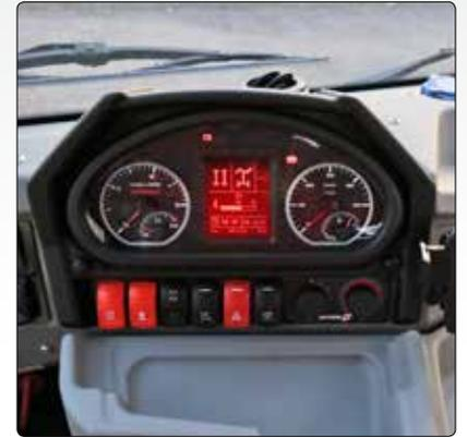
Die zentral in das Armaturenbrett eingearbeitete **Anzeigeeinheit** ermöglicht dem Fahrer eine uneingeschränkte Sicht nach vorne sowie ein komfortables Arbeiten. Über dieses Kombi-Instrument werden dem Bediener alle wichtigen Informationen wie Geschwindigkeit, Betriebsstunden, Lenkungsart, Flüssigkeitsstände uva. angezeigt.
