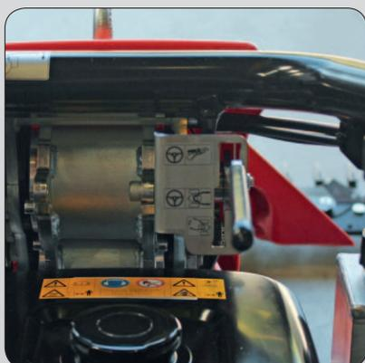
Je nach Arbeitssituation wird die **ideale Lenkungsart** gewählt. Entweder wird die Aktivlenkung durch seitliches Drücken auf den Holm oder mittels Handhebel (optional) ausgelöst. Die Antriebsräder drehen sich dadurch unterschiedlich schnell. Somit werden präzise Lenkmanöver komfortabel ausgeführt.
