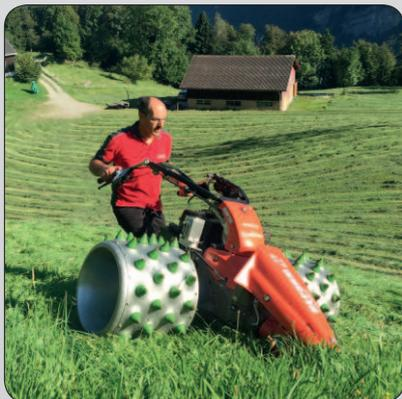
Der tiefe Geräteschwerpunkt und die breite Achse sorgen für **Standfestigkeit auch in extremen Hanglagen** von bis zu 120%. Die konstruktiv weit hinten platzierte Achse garantiert ohne Zusatzgewichte in jeder Situation ein optimales Balkenauflegegewicht.
