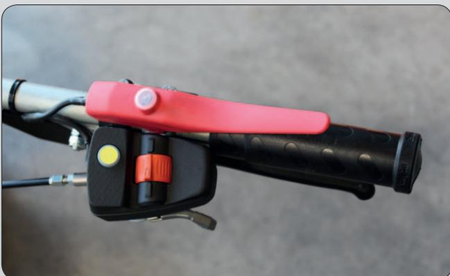
Am rechten Holm wird über ein freilaufendes Daumenrad die optimale **Fahrgeschwindigkeit** eingestellt.
