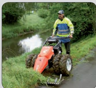
Der **Kommunalbalken** mit Schwinghebelführung gewährleistet einen sauberen, verstopfungsfreien Schnitt.
