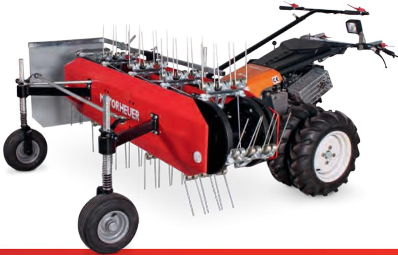
**Umkehrfräse UF 70 / 80 / 90 / 100** mit höhenverstellbarer Gitterwalze, Arbeitsbreite 70, 80, 90 und 100 cm
