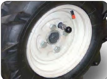
Die **Radabschaltung** ist für den Schleppbetrieb notwendig und ermöglicht auch das Rangieren des Mähers bei abgestelltem Motor.
