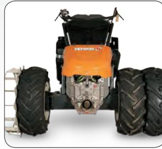
**Je nach Einsatz** kann der Reform M14 mit der entsprechenden Zwillings- oder Zusatzbereifung ausgerüstet werden.
