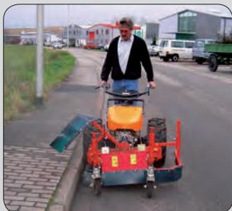
**Wildkrautentferner WE 90** mit gegenläufigen Teller- oder Zopfbürsten und Stützrädern zur Reinigung von Pflasterflächen und Bordsteinkanten.
