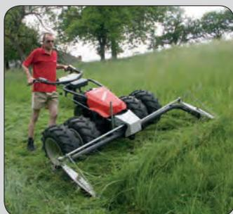
Das verstopfungsfreie **Portal- Doppelmessermähwerk** sichert Ihnen auch in Extremlagen hervorragende Mähleistungen.
