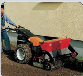
Die **Aufbau-Sämaschinen SM 75/90** oder **100 M** zur Kreiselegge liefern eine gleichmäßige Saat. Der Antrieb der Säwelle erfolgt über die Gitterwalze.
