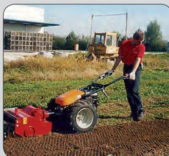
Die **Umkehrfräse UF 80** mit höhenverstellbarer Gitterwalze arbeitet Steine und alte Grasnarbenteile besonders gut ein.
