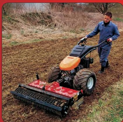
Kreislegge UK 75 / 90 / 100 / 125 mit höhenverstellbarer Gitterwalze, Arbeitsbreite 75, 90, 100 und 125 cm
