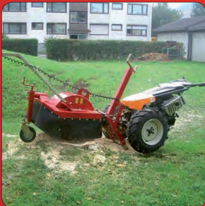
**Baumstrunkfräse SF 50** mit gehärtetem Fräsrads, 50 cm Scheibendurchmesser
