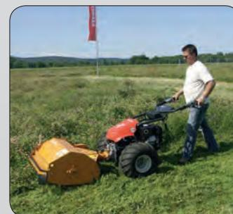
Beim **Schlegelmäher FMF 80** mit Heckrolle ist die Schnitthöhe von 45 bis 110 mm einstellbar.
