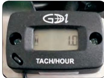
Mit dem digitalen **Betriebsstundenzähler** können die geleisteten Arbeitsstunden, besonders im überbetrieblichen Einsatz, einfach erfasst werden.
