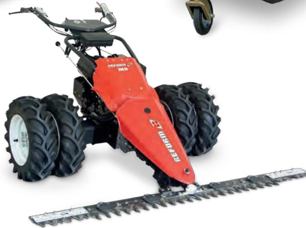
**Rotoflex-Mähtrieb** mit Freischneidebalken Pfeilschnitt T61 (weitere Balken in der Übersicht)
