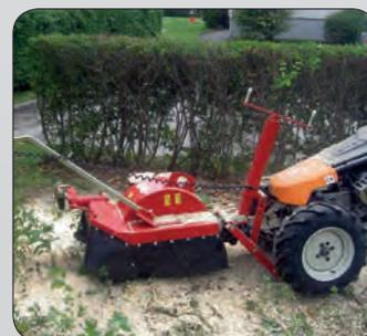
**M14 mit Baumstrunkfräse SF 50**, ein schlagkräftiges und doch handliches Gerät, dass selbst an engen Stellen noch arbeiten kann.
