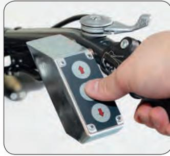
**Bedienpaneel** für die komfortable, stufenlose elektrohydraulische Fahr- antriebsverstellung
