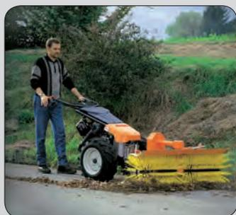
Mit der seitlich verschwenkbaren **Kehrmaschine** haben Sie die größten Verunreinigungen rasch beseitigt.
