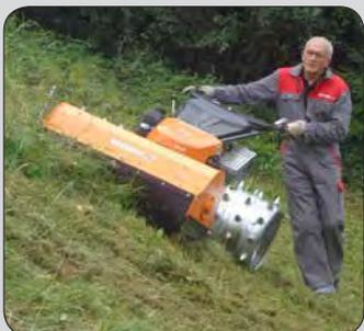
**Schlegelmäher RTK 100 F5** beim Einsatz im extremen Steilhang mit 3-reihigen Stachelwalzen.
