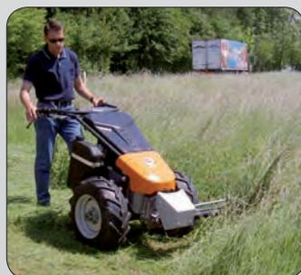
Das **Doppelmessermähwerk mit seitl. Antrieb** eignet sich besonders gut zum Mähen entlang von Bach- und Flussböschungen oder entlang von Leitplanken.
