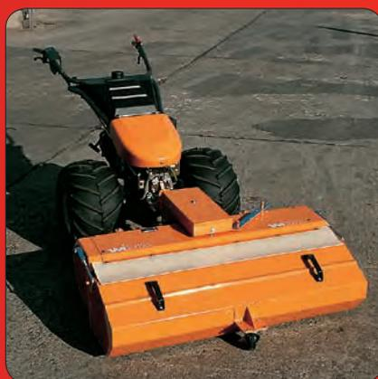
Kombi-Kehrmaschine 2400 leichtere Ausführung, 90 und 100 cm, Stützräder, schwenkbar, Option: Schmutzbehälter, Seitenbesen
