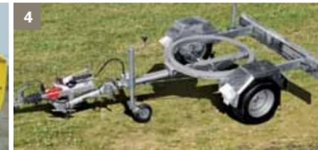
**4- GEBREMSTES FAHRGESTELL**, vollverzinkt, mit höhenverstellbarer Zugdeichsel
